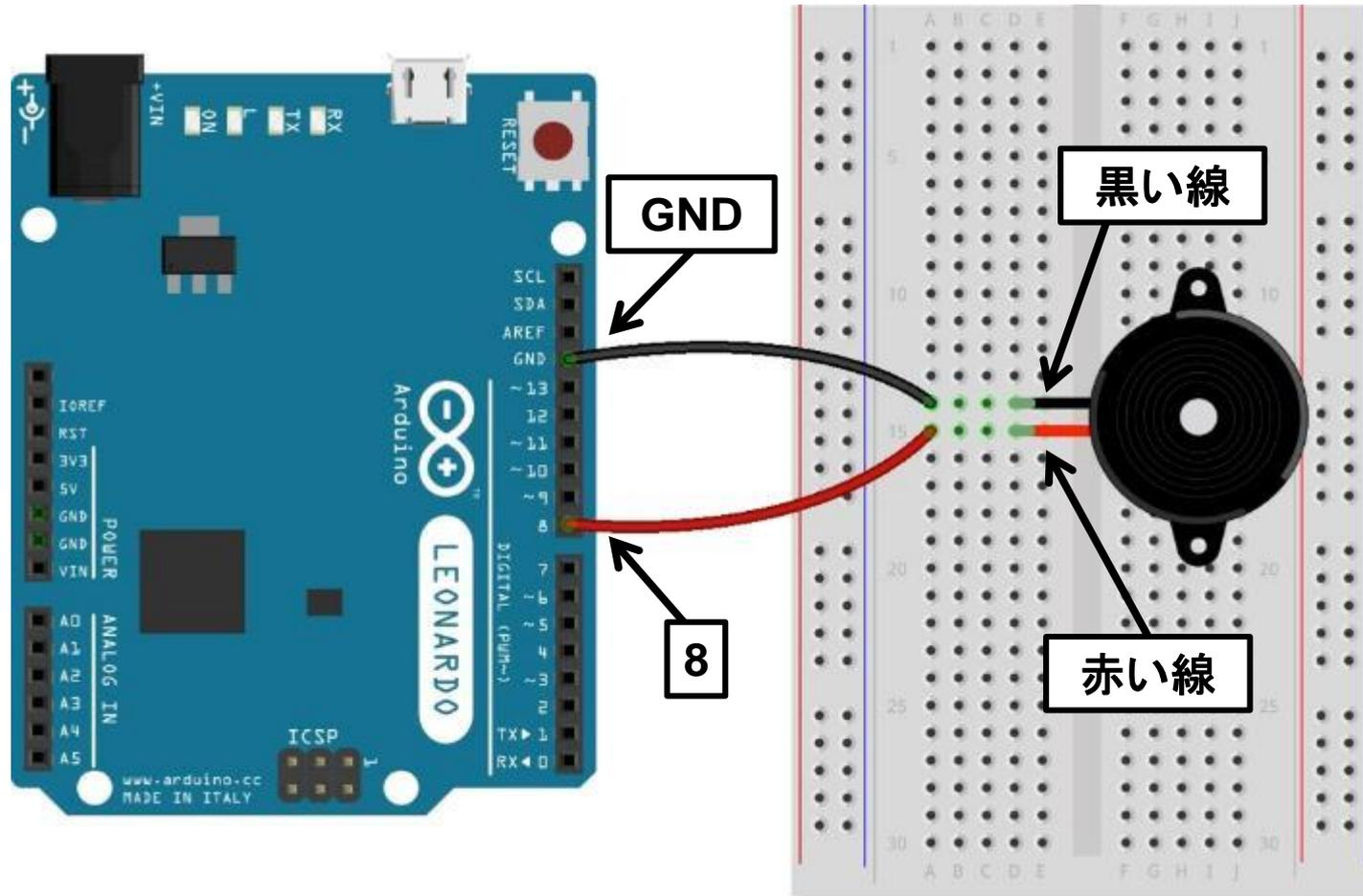
圧電スピーカを直接Arduinoに挿してもよいが、線が細くて接触がよくないのでブレッドボードを介して接続する。
