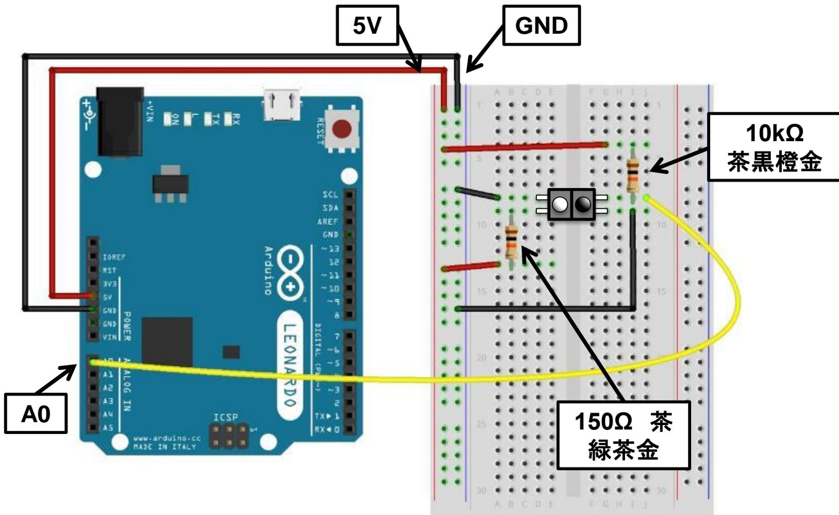
光センサや曲げセンサと同じように、アナログ入力を使って電圧の変化を読み取ろう
