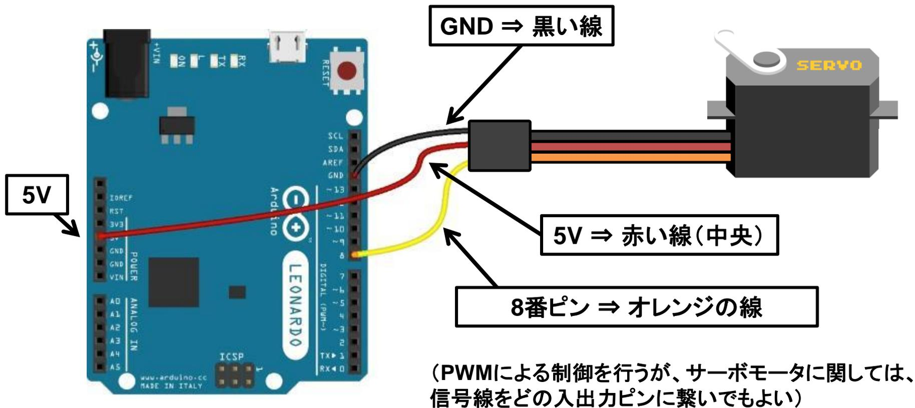
※モータを駆動するときには大きな電流が流れるため、普通は外部電源から電力供給を行う。今回は小型のモータを使用しているため、マイコンボードから電力供給している。
